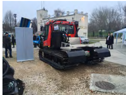
Önjáró rézsűkasza Pistenbully Allseason 100, kaszafej és pótkocsi
