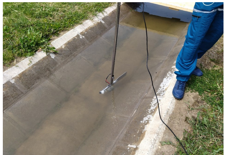
Vízhozammérés forgószárnyas műszerrel
