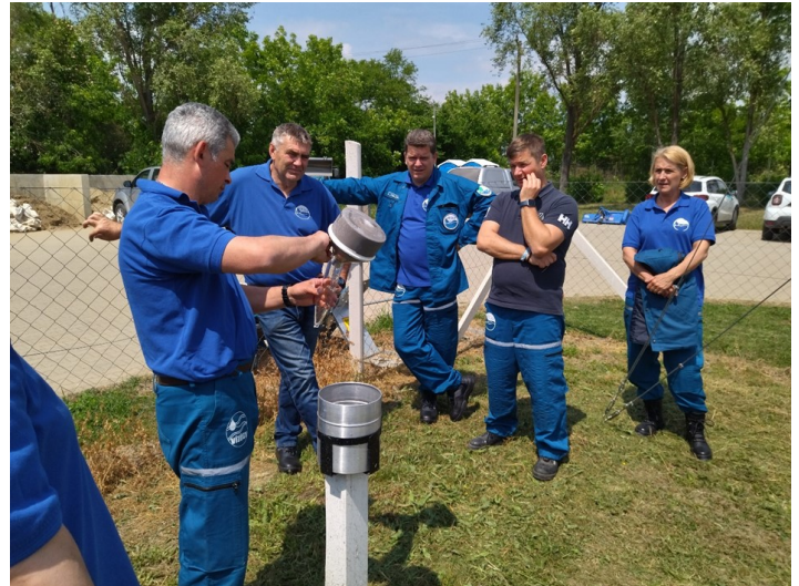
A Hellmann-féle csapadékmérő összegyűjtött csapadékvizének mérése
