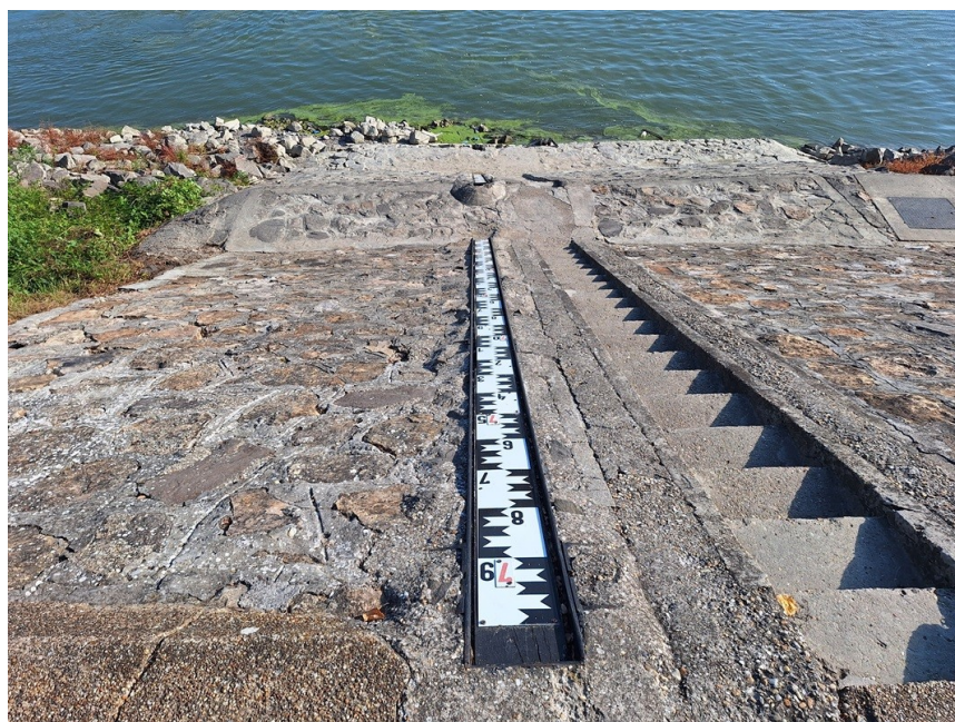
A Duna (Mohács) vízrajzi állomás állítható rézsűs vízmércéje fölülről (Fotó: Kulcsár László, 2025. 09. 30.)
